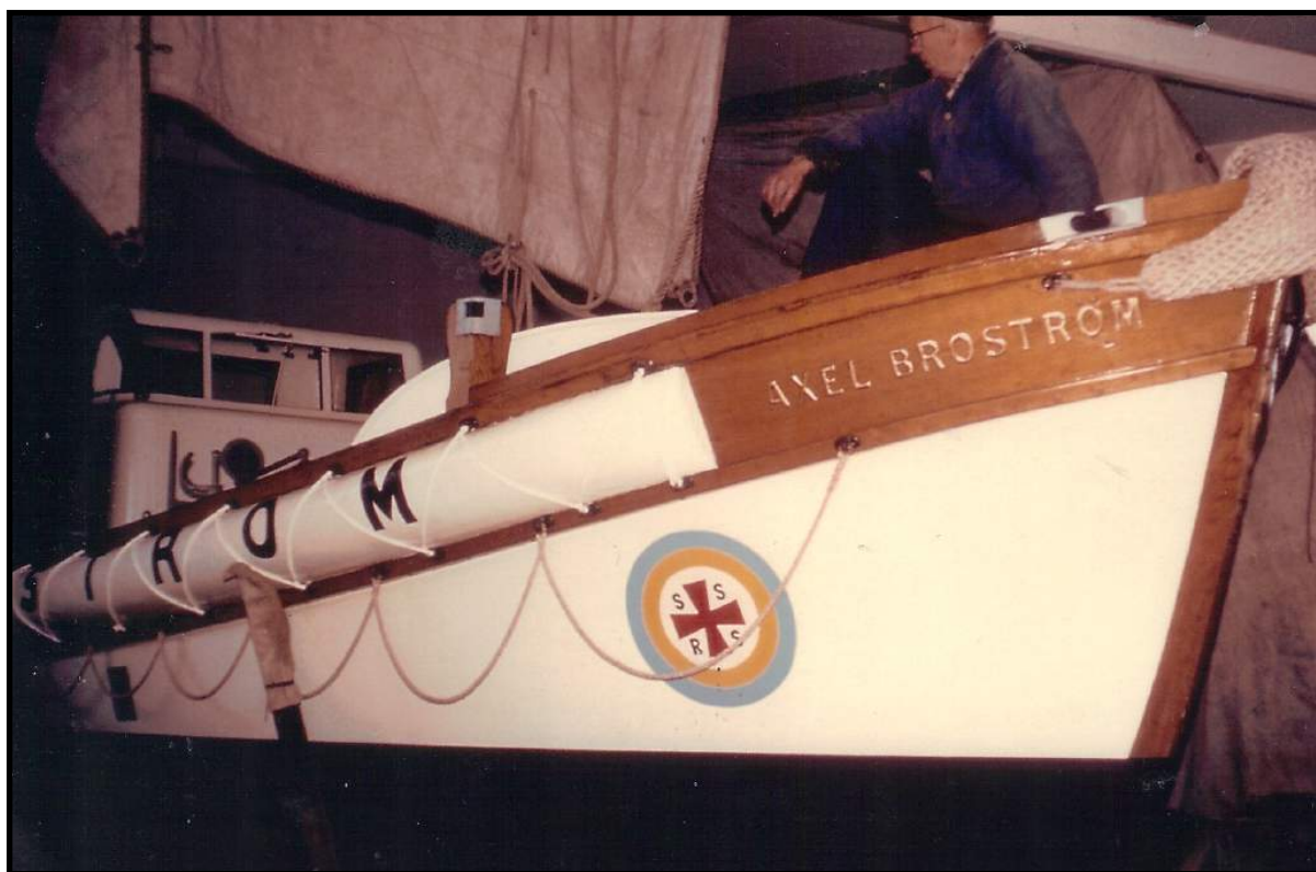
Bild 14: Axel Broström - som ersatte Hjälparen som räddningsbåt - byggdes på Hjalmar Johanssons varv i Långedrag. Bilden är tagen runt 1970 inne i båthuset. För att testa bärigheten på båten vältes den upp och ned, i samband med bygget, för att se om den rätade upp sig själv. Det gjorde Axel Broström! Vi ser en av besättningsmännen Karl Svensson - "Svensa Karl" - sittande på fördäck. Den första maskinen var en bensinare, men då pålitligheten inte var så bra så byttes den snart ut till en dieselmotor. Räddningsverksamheten upphörde 1973.
